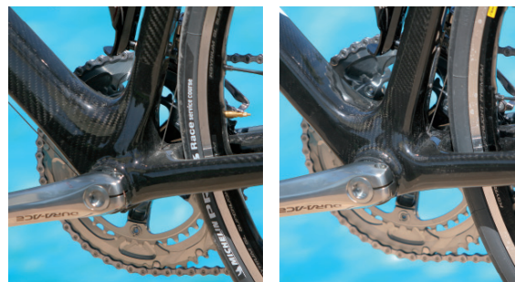
Mufa suportowa w Advanced SL (z prawej) zbudowana w technologii Fusion ma mniejsze rozmiary. W Advanced i Advanced Defy skorupowa rama ma większe przekroje i masę
